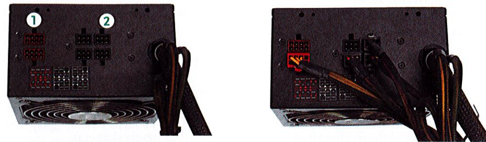
Rys. 63.1. Zasilacz z odłączanymi wtykami zasilania 1 – wtyki zasilania PCI Express, 2 – wtyki zasilania molex i S-ATA
